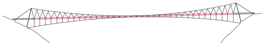
Phase 3: Montage der 35 Brückenträgerelemente, Einschleiben der Elemente entlang der Hilfsseile mit Rollkonstruktion, Richten und Spannen der Konstruktion
